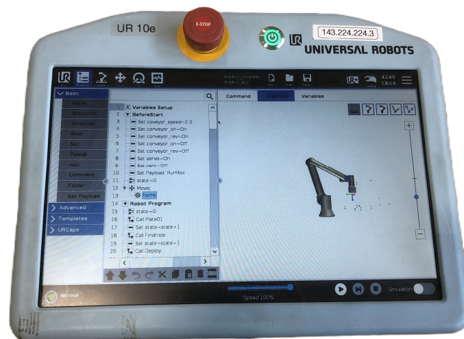
Abbildung 3.4: Teach-Pendant samt Ausschnitt des Programmbaums und Programmknoten
