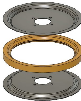
Abbildung 3.1: Zusammensetzung der Seilführungsscheibe
